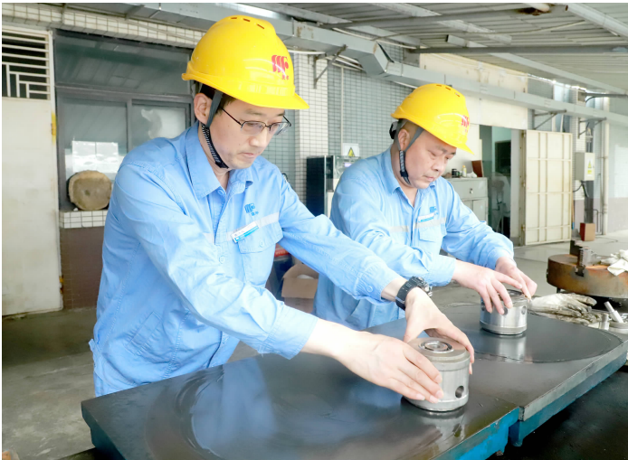
▲ 科技公司维修车间员工修复压缩机气阀
